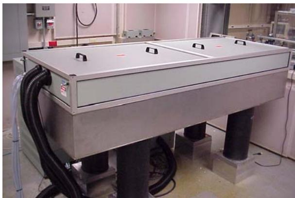
**Fig. 5 Gen IV laser shock peen apparatus**
